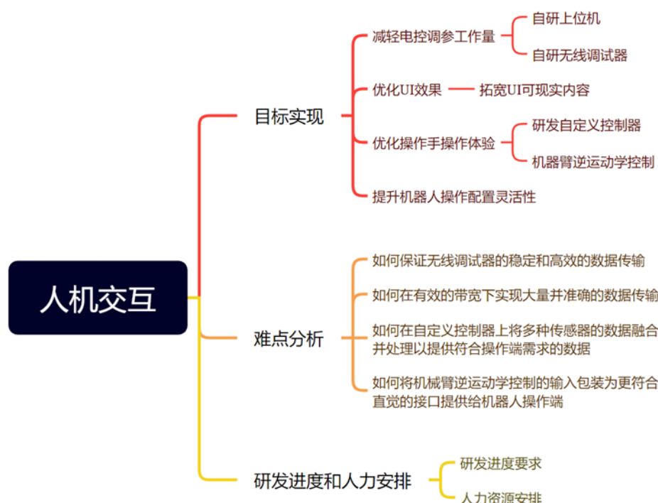
图 2-13 人机交互系统设计框架
